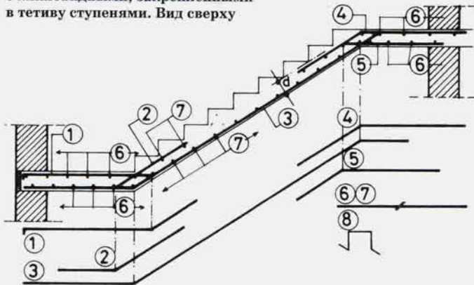
Рис. 4–20. Армированная монолитная железобетонная лестница (1–8 — железные элементы, консигнационные знаки).
