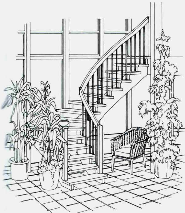
Рис. 3-17. Прямолинейная внутренняя лестница с поворотом на 1/4 в начале пути.
